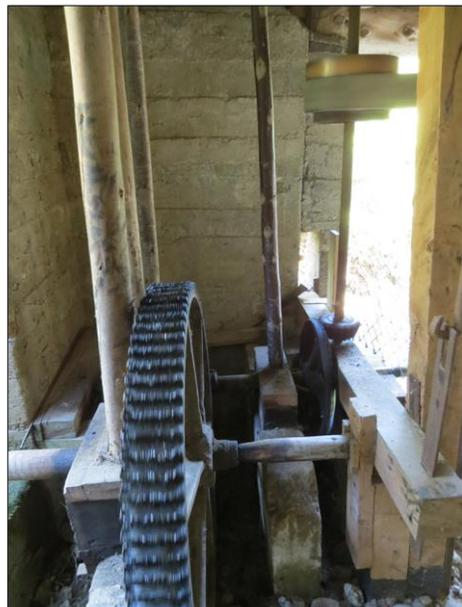
Figura 12 : Sistema de engranajes y poleas que permiten la labor de la molienda producido por el giro de la piedra encimera por sobre la piedra solera. . Molino de Rodeillo, Pichilemu. Fuente: Autora, 2015.
